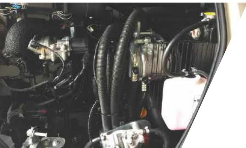
Une ouverture ample de capot donnant aisément l'accès à tous les filtres, remplissage gasoil, distributeur hydraulique, huile moteur, radiateur...
