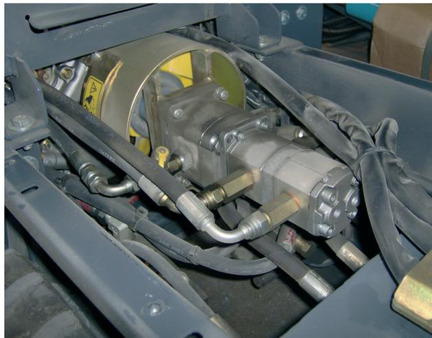
DETAIL DU SYSTEME DE REFROIDISSEMENT D'HUILE HYDRAULIQUE (breveté)
