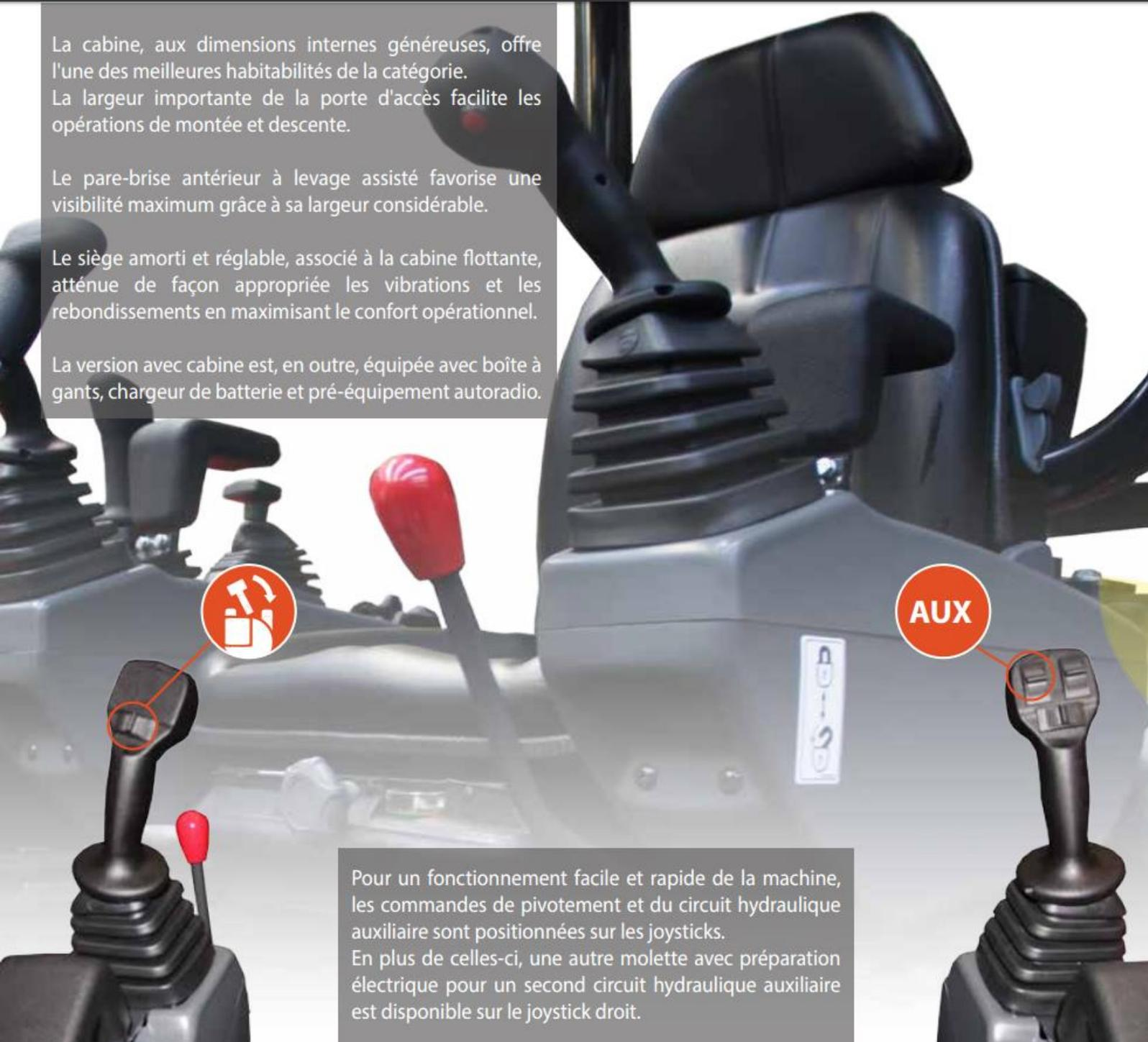
Pour un fonctionnement facile et rapide de la machine, les commandes de pivotement et du circuit hydraulique auxiliaire sont positionnées sur les joysticks. En plus de celles-ci, une autre molette avec préparation électrique pour un second circuit hydraulique auxiliaire est disponible sur le joystick droit.
